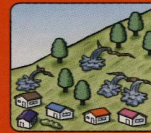
斜面から水がぶき出す
